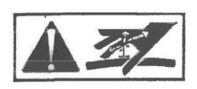
Du bør kontrollere at alle hydraulikkkoblinger er tette, og at alle slangene og beslagene er uskadde, før du aktiverer hydraulikksystemet. Etter at traktorens motor er stoppet, bør du i tillegg kontrollere at det ikke er trykk i hydraulikkslangene. Dette gjøres ved å aktivere hydraulikksystemet.
